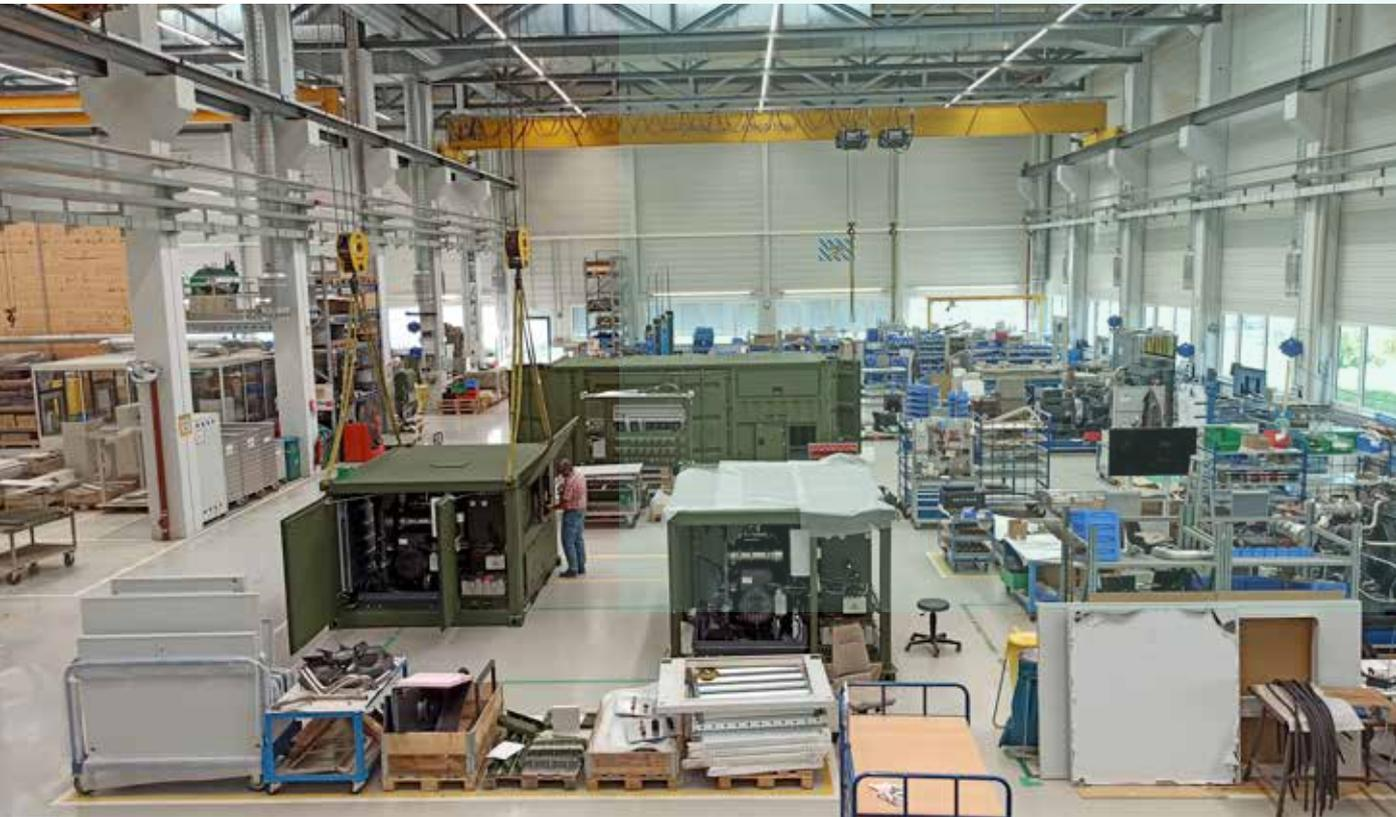
*In der Lagerhalle des Unternehmens Vincorion in Altenstadt werden Generatoren für die Bundeswehr händisch zusammgebaut.*
